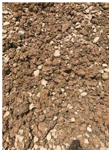
Stark verunreinigtes Altschotter als Ausgangsmaterial für die Wiederaufbereitung.
